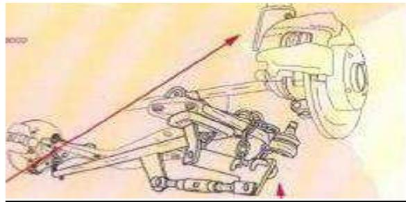
Con la leva staccare il braccio oscillante con barra di torsione sarà facile.
